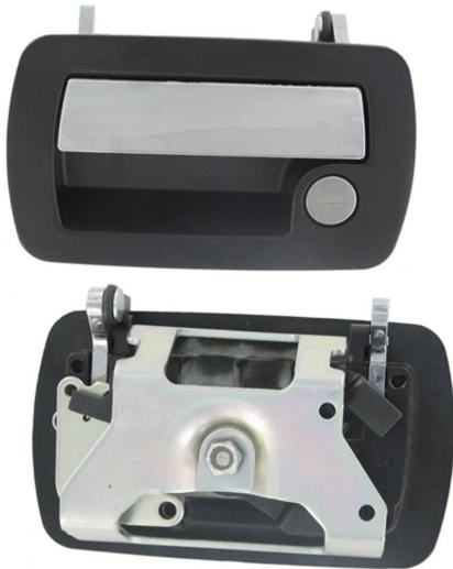
这款嵌入安装翻板把手是对我们出产的 030-0450 翻板把手重新进行设计后的产品，用于旅行车辆和专用车辆的车厢门和进出门。内含与前期产品同样经过检验的机械零部件，外观更为时尚，可以用于 FMVSS 206 应用场合，可以电动锁定，还具有两点遥控支轴盘和锁挡片致动方式。
